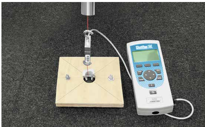
Тестирование прочности фиксаторов для ковриков
